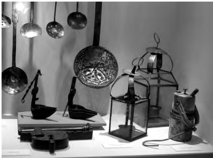
que al mezclarse con el agua producían gases que salían por un tubito colocado en la parte lateral superior y que al aplicarle una cerilla su combustión producía una potente luz.
